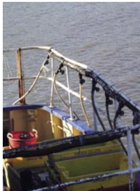
Eksempel på enkelt vanningssystem koplet til spylepumpa.
